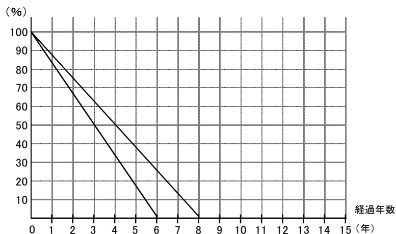
設備等の経過年数と賃借人負担割合（耐用年数6年及び8年、定額法の場合） 賃借人負担割合（原状回復義務がある場合）
